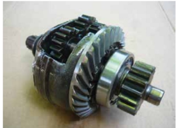
Differentieel achterwielzijde ▲ en zijspanzijde ▼
