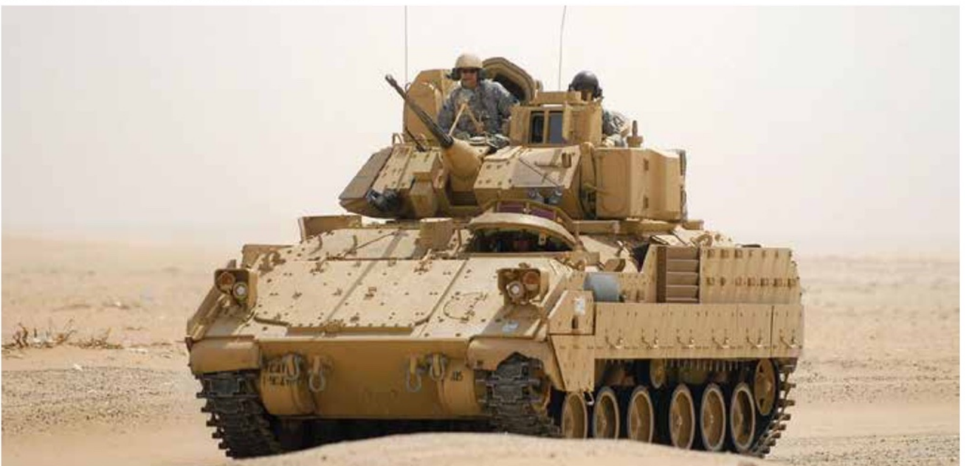
M2A3 met fluted barrel, ontbrekend drijfscherm, big foot tracks en vergrote optiek voor de schutter (drie klepjes zijn geopend). De CIV is net zichtbaar.
