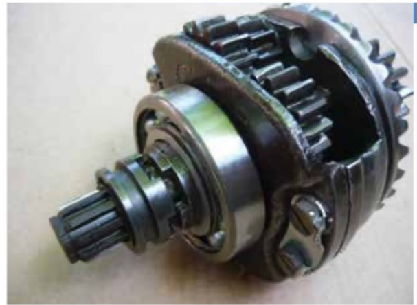
Differentieel achterwielzijde ▲ en zijspanzijde ▼
